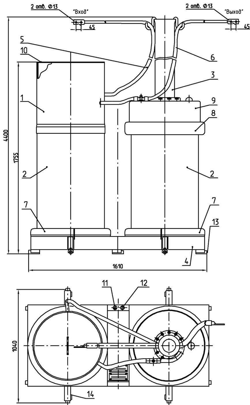
1, 2, 3 – цилиндры; 4 – основание; 5, 6 – шины высоковольтные; 7, 8 – экраны; 9 – корпус;
