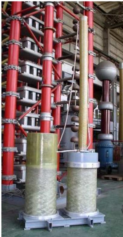
Фильтр предназначен для применения в составе испытательных стендов при проведении испытаний изоляции силовых трансформаторов классов напряжения 72,5÷1150 кВ с измерением частичных разрядов с целью подавления помех в питающем напряжении до нормируемого уровня.
